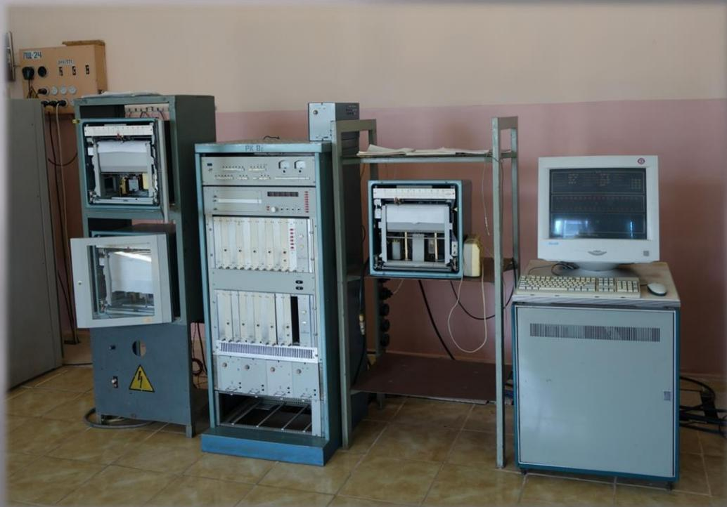
Радиометр РК-8с – 8-канальный компенсационный радиометр и корреляционный приемник для работы с ДКР-1000 в корреляционном режиме. Полоса регистрации 500 кГц, постоянная времени 0.1 с.
