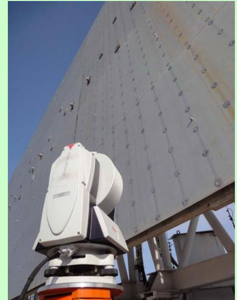
Лазерный трекер Leica AT401
