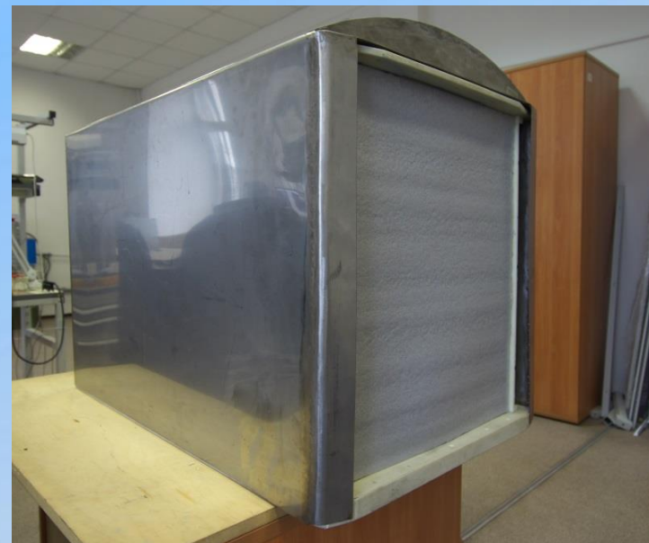
Теплоизоляция передней панели: Пенополиэтилен(ППЭ)
