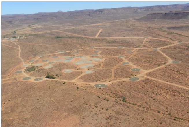
Забетонированные площадки под антенны центральной группы, 03-2014
